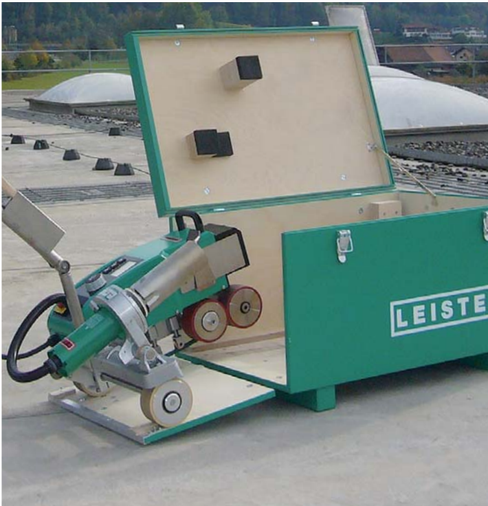
In der robusten Gerätebox ist der VARIMAT V2 perfekt geschützt. Er kann einfach aus- und eingefahren werden.
