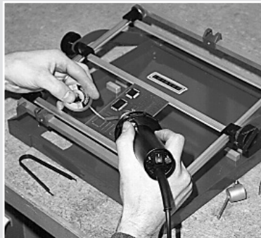
Entfernen des alten Lötabbaus mittels Heissluft und Kupfersauglitze.
