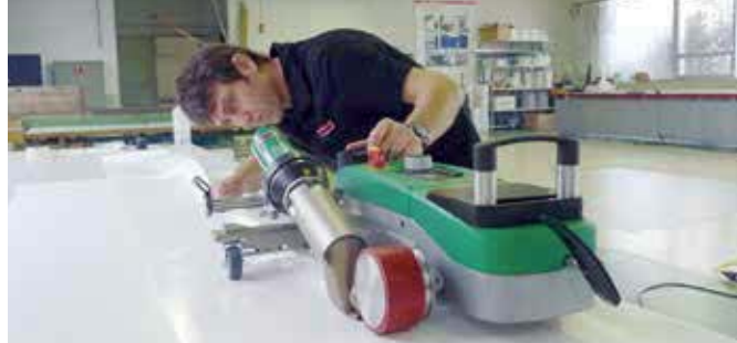
Einfaches Saum- und Kederschweißen mit dem Saum-/Kederkit.
