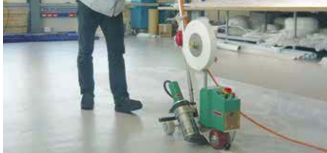
Aufschweißen von Gurtbändern in Höchstgeschwindigkeit.
