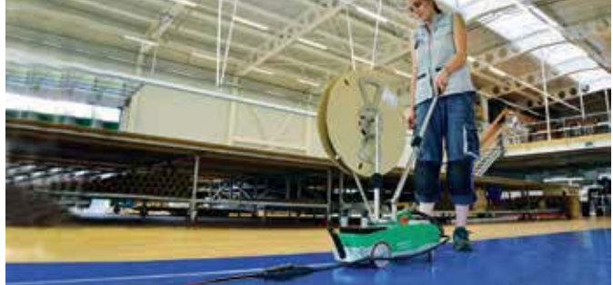
Wirtschaftliches und ergonomisches Schweißen von Verstärkungsbändern.
