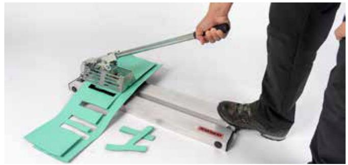
Prüflinge in einheitlicher Grösse, schnell hergestellt mit dem COUPON CUTTER 500.
