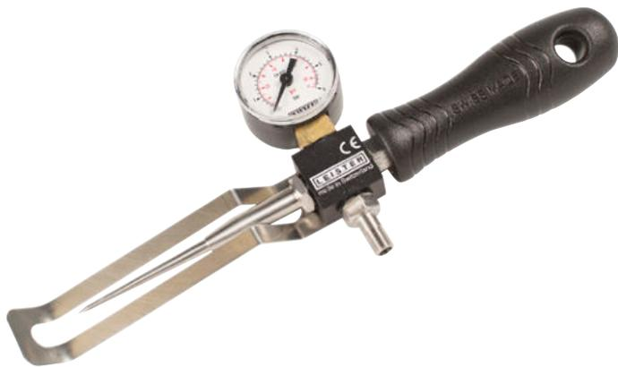
Die Prüfnadel ist ein zuverlässiges Druckluftprüfgerät zum Testen der Dichtigkeit von Überlappnähten mit Prüfkanal. Entwickelt zur Qualitätssicherung von Schweißnähten im Tiefbau, im Tunnel und auf der Deponie.
