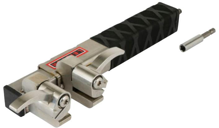
Das Zugprüfgerät EXAMO 100 prüft die Schweißnahtqualität von Geomembranen. Vorteile: werkzeugloses Einspannen der Prüflinge, konstante Zuggeschwindigkeit sowie müheloses Ziehen der Proben mit dem Akku-Schrauber.
