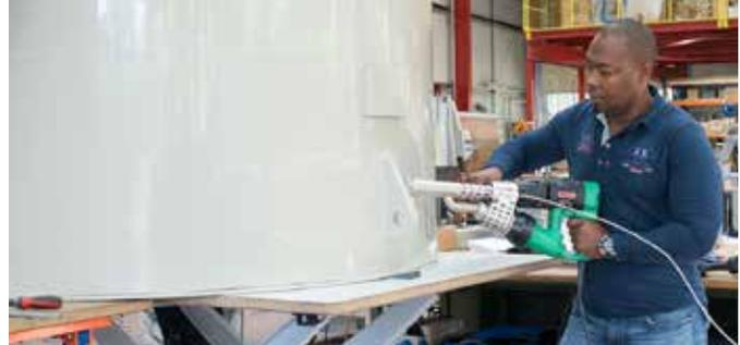
FUSION 3C beim Schweißen einer Kehlnaht.
