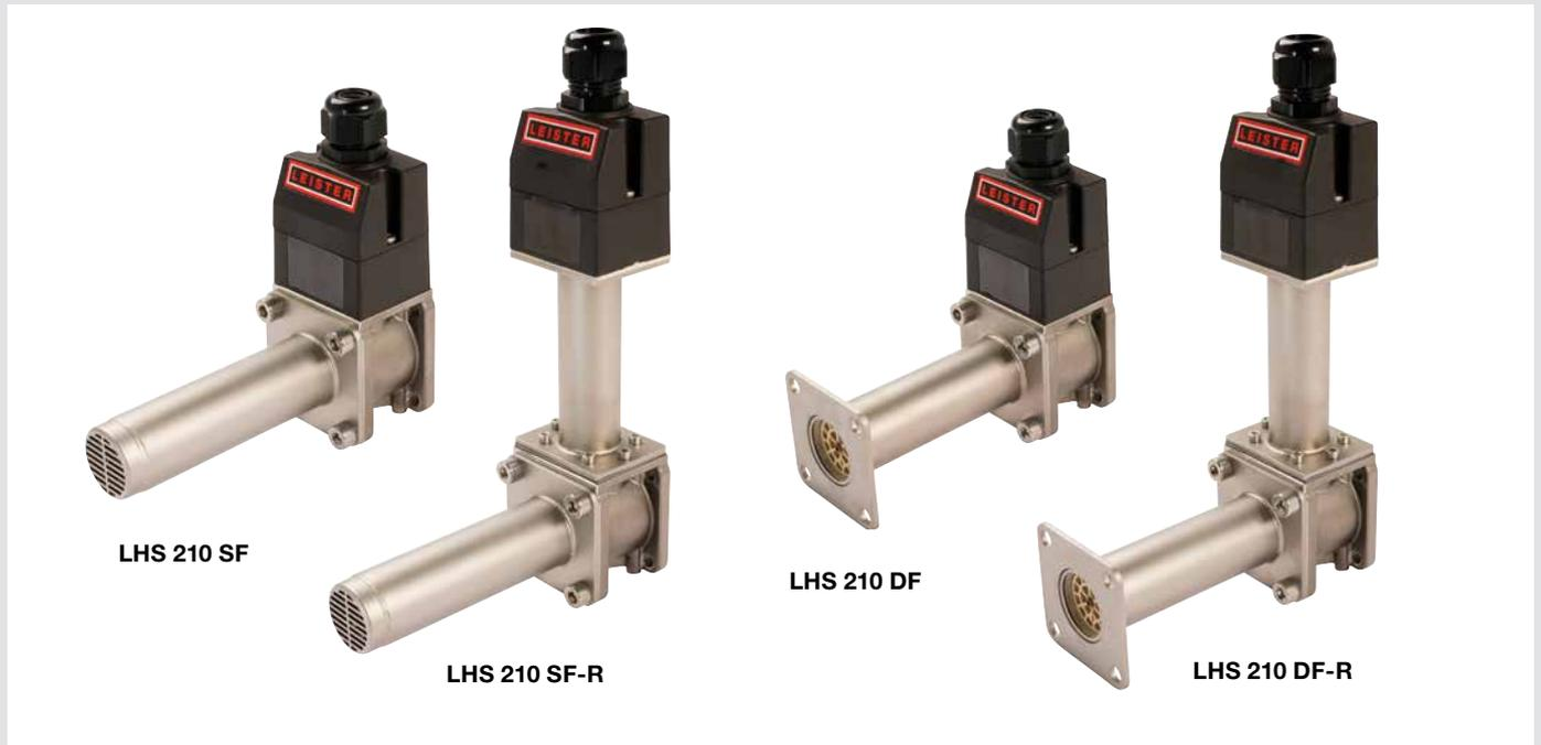
Das Anschlussgehäuse des LHS 210 befindet sich ausserhalb des Luftstroms, was die Vorteile hat, dass die Luft den Luftherhitzer ungehindert durchströmt und kaum Druckverlust entsteht. Zudem ist das Anschlussgehäuse des LHS 210 SF-R und DF-R vor Überhitzung geschützt, wodurch die Möglichkeit besteht, mit Lufteinlasstemperaturen von bis zu 350 °C zu arbeiten.
