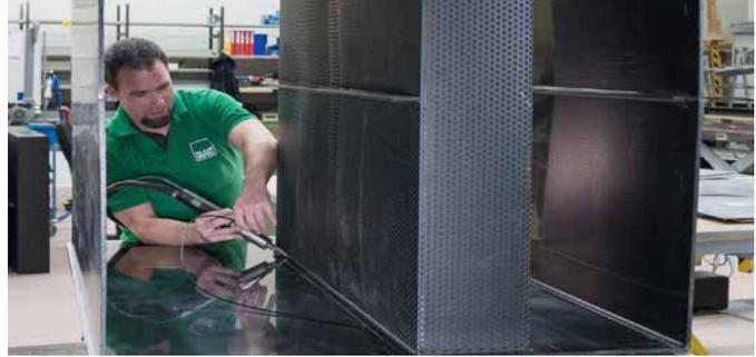
Angenehmes Ziehschweißen mit der leistungsstarken, leichten DIODE PID
