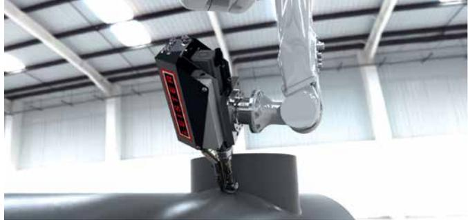
WELDPLAST 200-i / 610-i – Roboter-Extrusionsschweißen und 3D-Druck, konzipiert für den automatisierten Dauerbetrieb
