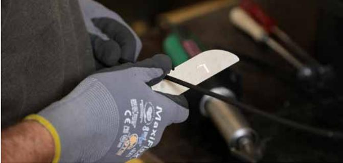
Oxydschicht entfernen am Schweißdraht
