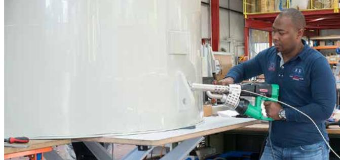
FUSION 3C beim Schweißen einer Kehlnaht
