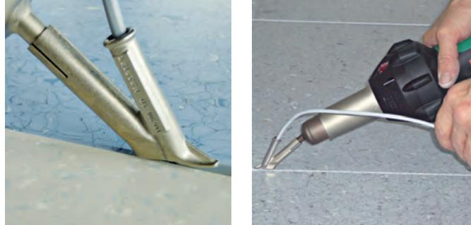
Zum präzisen verschweißen von Fussbodenbelägen
