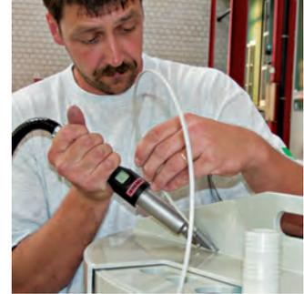
Drahtschweißen mit dem kompakten, leichten WELDING PEN R.
