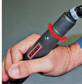
Der drehbare Schlauchadapter am WELDING PEN erleichtert das Arbeiten.
