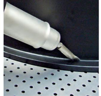
Optimal für Warmgasziehschweißen im Behälter- und Apparatebau
