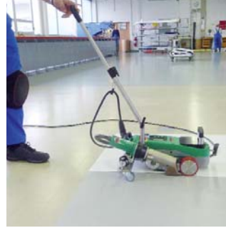
Konstante, faltenfreie Überlappschweißungen
