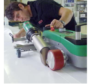
Einfaches Saum- und Kederschweißen mit dem Saum-/Kederkit
