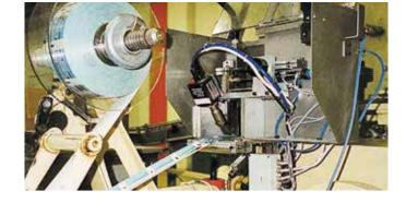
Lufterhitzer und Gebläse zum Trocknen von Etiketten. Die schnelle Trocknung ermöglicht hohe Durchlaufgeschwindigkeiten.
