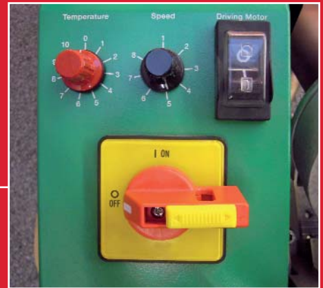
Einfache Bedienung: Sicheres Einstellen von Temperatur und Geschwindigkeit
