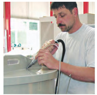
Gebläse ROBUST als Luftversorgung für den WELDING PEN.
