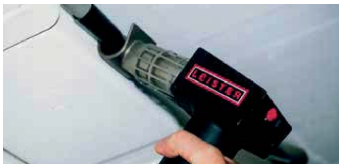
Schrumpfen von Kabeln mit dem GHIBLI.
