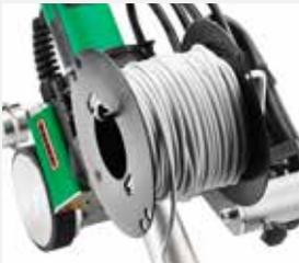
**Werkzeuglose Montage / Demontage des De-reelers:** Falls der de-reeler nicht eingesetzt werden kann, kann der Schweißdraht trotzdem kontrolliert in die Schnell-schweissdüse geführt werden.
