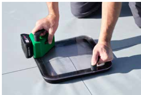
VACUUM PLATE 100-LP Akkubetriebenes Prüfgerät: Akkubedarf mindestens 4 Ah, Lieferung in Europa mit zwei 4 Ah-Akkus.
