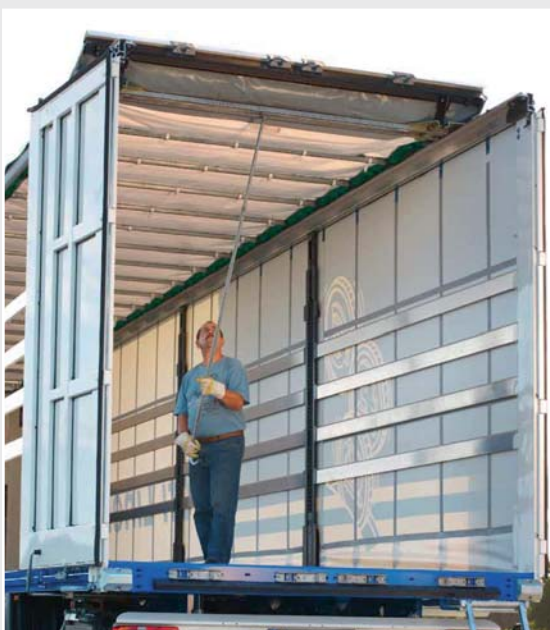
Verstärkungsstreifen für Fest- und Schiebeverdecke von LKW-Planen. (Bilder: Krone)
