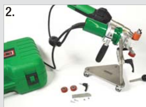
Version mit Führungshilfe für das Attika-Schweißen
