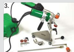
Version mit Führungshilfe und Verlängerung für das Attika-Schweißen
