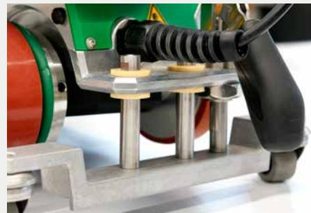
Kunststofflager mit Metallstift, das zu schnellerem Verschleiss neigt, was die langfristige Zuverlässigkeit bei intensiver Nutzung einschränkt.
