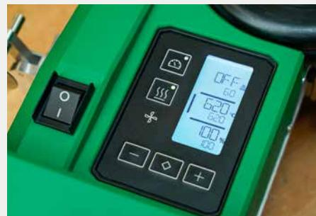
Eine übersichtliche Benutzeroberfläche mit einfacher Drucktasten-Navigation und klaren Anzeigen, zuverlässig für Standard-Schweissaufgaben.
